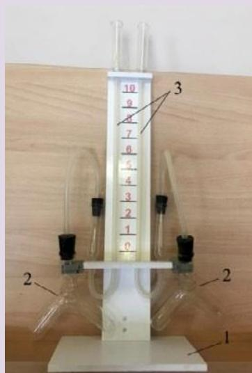
Прибор состоит из подставки, на которой закреплены две манометрические трубы, которые соединяются с сосудами Ландольта с помощью пластиковой трубы с пробками (рис. 5). Между манометрическими трубками на панели нанесена шкала для наблюдения уровня жидкости в трубках. Окрашенной жидкостью может быть раствор любого красителя в воде.
