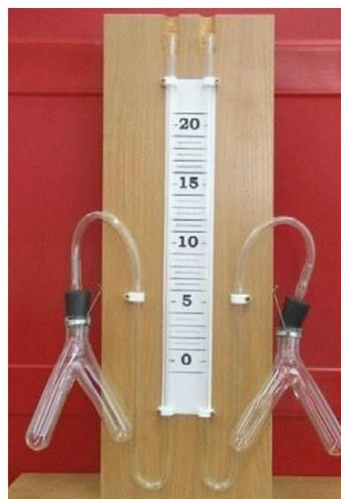
**Рис. 19.** Прибор для определения скорости химических реакций
