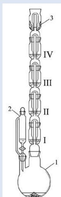
**Рис. 16.** Аппарат для проведения химических реакций (АПХР): 1 — двугорлая колба-реактор; 2 — делительная воронка для работы с токсичными веществами, позволяет добавлять необходимое количество жидкого реагента в реакционную смесь, не допуская разгерметизации прибора; 3 — ёмкости (насадки) для жидких реагентов (поглотителей); 4 — колпаки; 5 — ёмкость (насадка) для сыпучих реагентов
