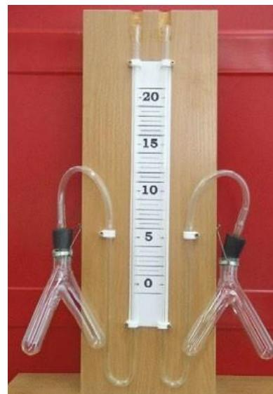
**Рис. 19.** Прибор для определения скорости химических реакций
