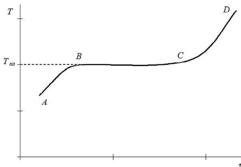
**Рис. 5.** Кривая охлаждения расплавленного вещества до температуры кристаллизации
