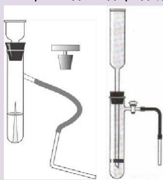
*Рис. 7. Прибор для получения и сбирания газов*
