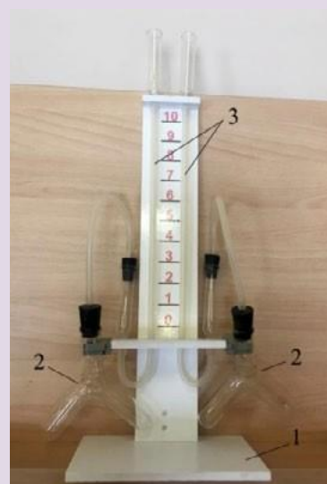
Рис. 4. Прибор для демонстрации зависимости скорости химических реакций от различных факторов: 1 — подставка; 2 — сосуды Ландольта; 3 — манометрические трубки
